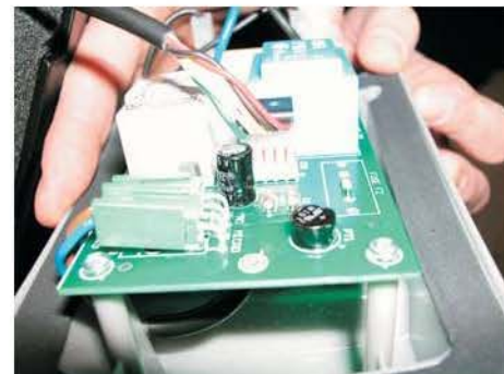
26) * Sostituire il fusibile T10A con quello da T16A presente nel kit
